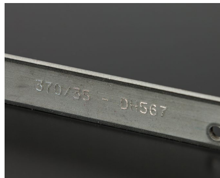
Markeren van gereedschappen en tools voor identificatie en traceerbaarheid
